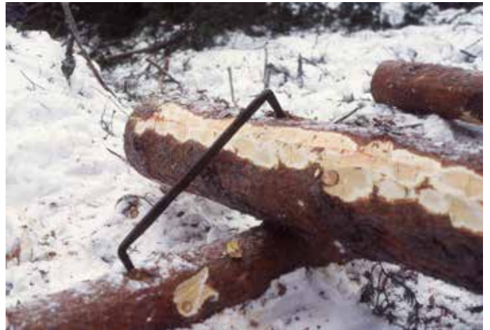
Hållhaken håller övre stocken still när man bearbetar den.
